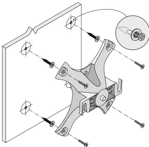
**Figura 6** Fixação do adaptador na parede (alternativa)
