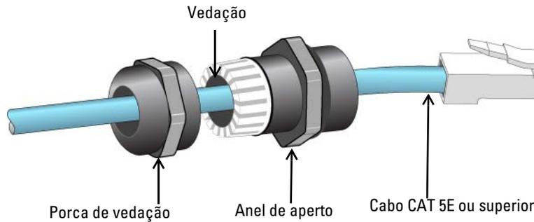
1. Deslize a porca de vedação sobre o cabo (sem o conector RJ45 encaixado na extremidade).
